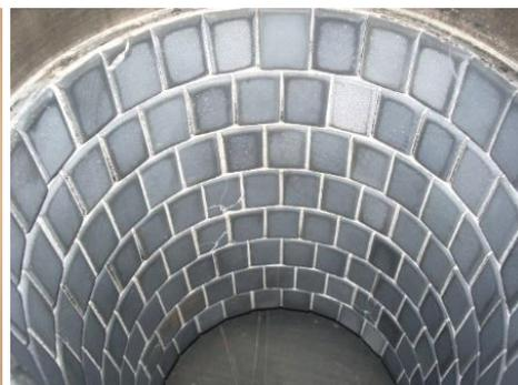
Рисунок 15 – Футерованный керамическими плитками барабан планетарной мельницы
